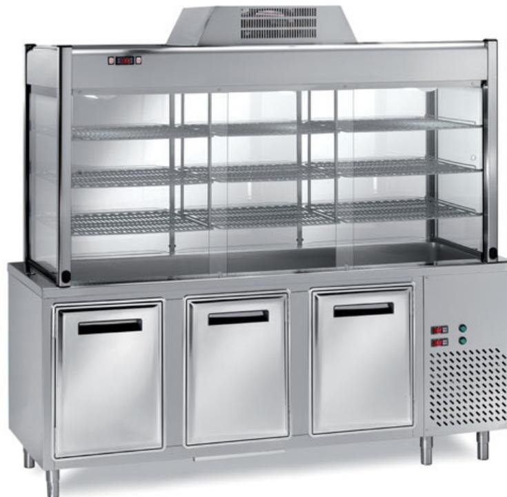
Elemento refr. con vetrina, vasca cap. 5 GN1/1 - 3 ante refr.+vano motore dotato di 2 controlli. Vetrina refr. dotata di cristalli scorr. e antine, 3 rip. ed illuminazione, mm 2000x700x2000h - VRP/20
