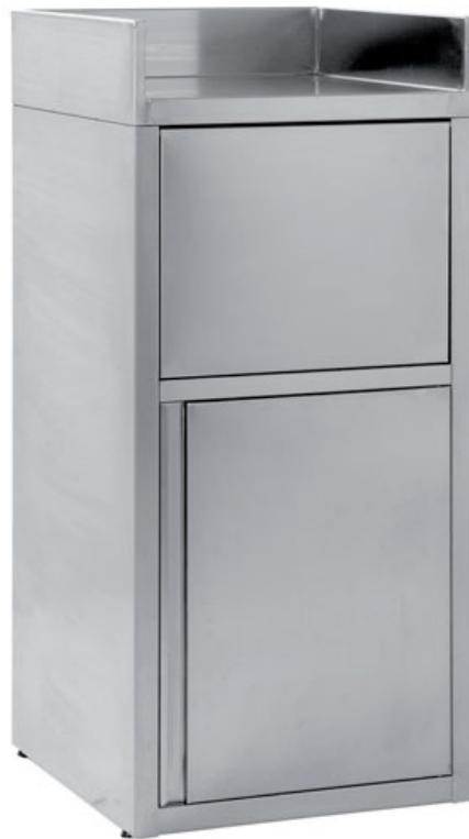
Tramoggia self-service per scarico vassoi. Piano con alzatina su 3 lati h 150 mm - anta a battente per alloggiamento pattumiera CRC/2 - sportello basculante per scarico vassoi mm 600x600x1300 h - TRC/2
