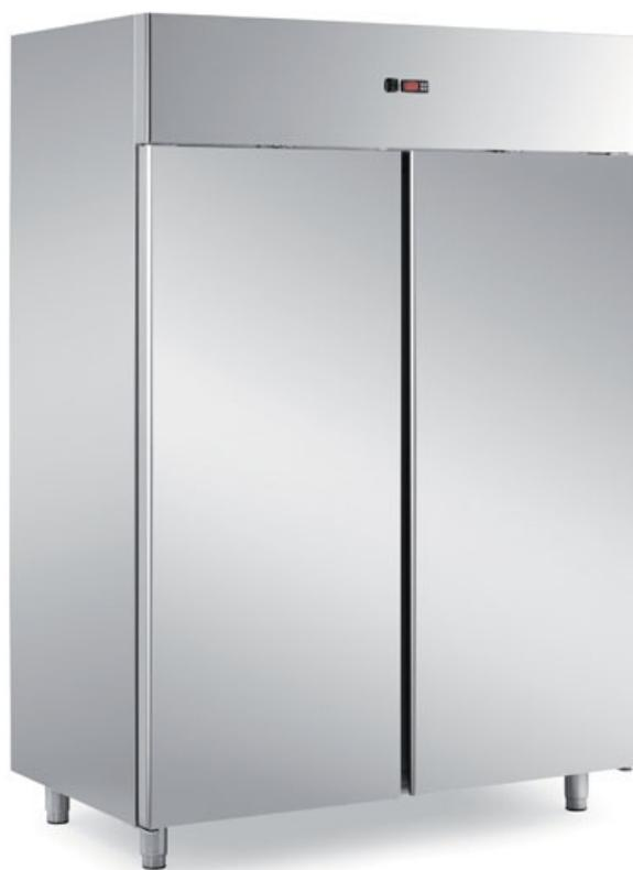
Armadio refrigerato BT in acciaio inox AISI 304 18/10, Lt.1400, isolamento spessore 75 mm con 3 griglie plastificate da mm. 530x650, sbrinamento ed evaporazione condensa automatico, controllo digitale. luce e chiusura a chiave comprese, Temp. -10/-20°C dim. mm 1480x800x2050 H - GSF500
