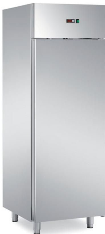
Armadio refrigerato TN in acciaio inox AISI 304 18/10, Lt.700, isolamento spessore 75 mm con 3 griglie plastificate da mm. 530x650, sbrinamento ed evaporazione condensa automatico, controllo digitale. luce e chiusura a chiave comprese, Temp. -2/+10°C DIM. MM 710X800X2050 H - GS250
