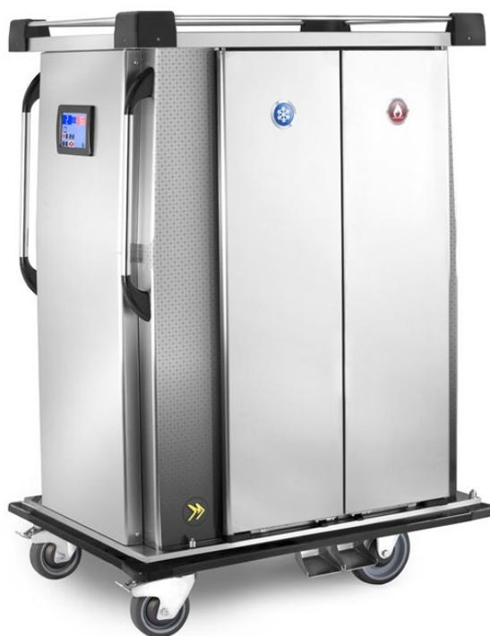
Carrello termorefrigerato a singola refrigerazione per mantenimento temperatura con un compartimento caldo e uno refrigerato per linea confezionamento pasti "fresco/caldo" o "cook and serve". Potenza 6 Kw. Capacità 24 vassoi mm.570x325. Dim. mm.1140x780x1430h. - MTC24/S
