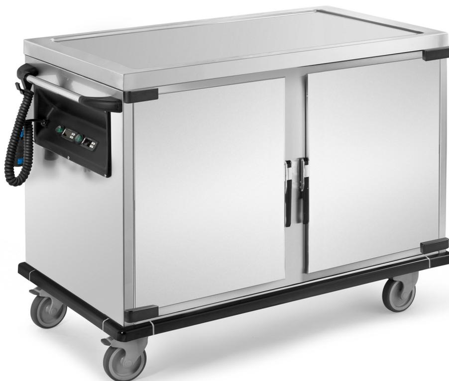
Carrello termico porta pasti con comparti stampati, riscaldamento a secco, piano di appoggio con vaso, n.1 vano riscaldato + n.1 vano neutro armadiati con ante a battente, 500W, capacità n.4xGN1/1 h 200mm + n.2xGN11 h 40mm, capacità 80/90 pasti, dim. mm.850x700x900h - 050.AB/1
