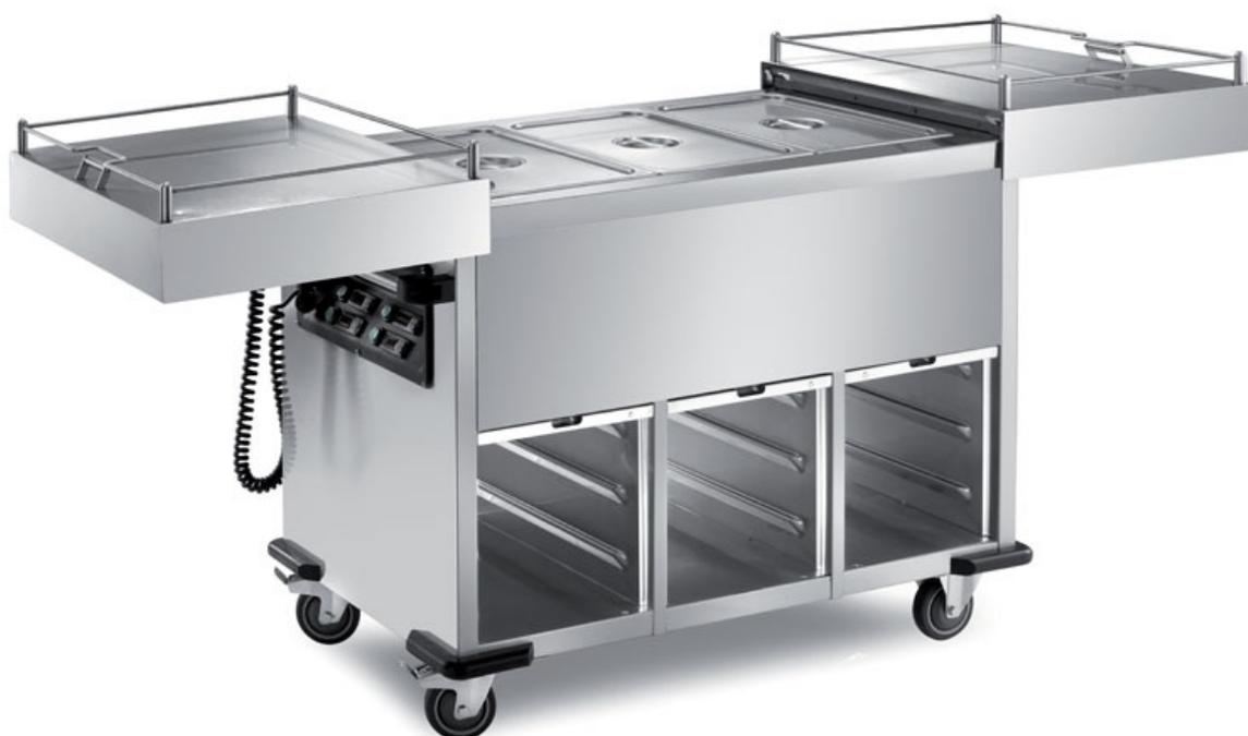
Carrello termico cap.3x1/1GN, vasca in 3 scomparti a 3 temp., n.2 vani neutri + n.1 vano riscaldato con ante basculanti a scomparsa, bacinelle escluse, mm 1200x700x900 h - 039.AC/1
