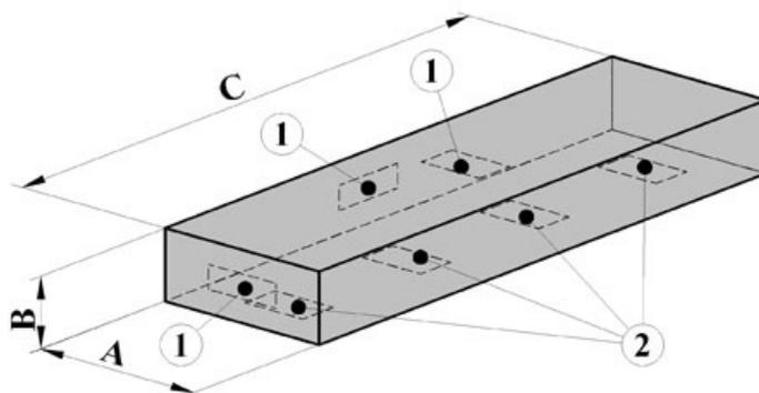
Plenum di aspirazione cm. 60x30x300h per cappe centrali 130 lung.320
