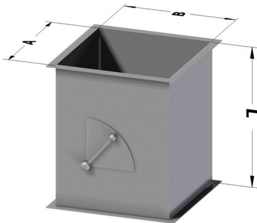
Canale quadro con serranda di taratura dim. cm 40x40x45 h. lamiera zincata - CSRO40/40LZ
