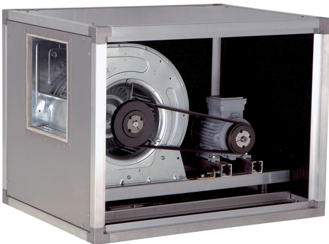
Aspiratore cassonato a trasmissione serie CBR ad 1 velocità, portata 14000 mc/h, prevalenza hs 50, 5,50 Hp - CBR-188/4INOX
