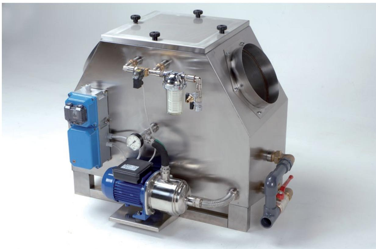
Abbattitore di fuliggine, funzionamento automatico con trattamento fumi ad acqua e filtraggio con filtri a reti microstirate G2 755. Portata 2500/4500 mc/h. - AGF/400
