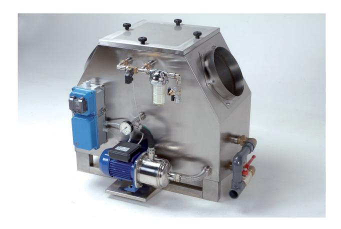
Abbattitore di fuliggine, funzionamento automatico con trattamento fumi ad acqua e filtraggio con filtri a reti microstirate G2 755. Portato 1000/2000 mc/h. - AGF/300
