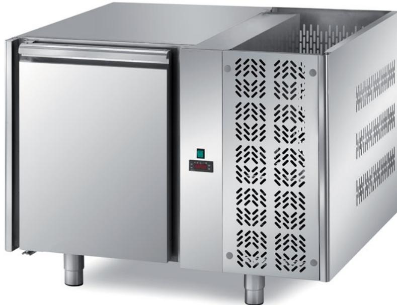
Umluft-Kühltisch, 1-türig mit Motor und einem geschlitzten Zwischenboden, ohne Arbeitsplatte
