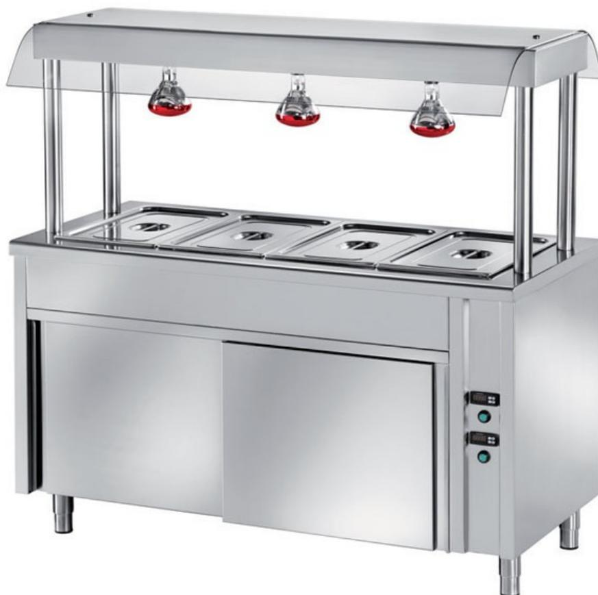
Elemento bagnomaria isola centrale. Vasca raggiata h200 per GN1/1 h150 (bacinelle escluse), cap. 3 GN1/1, vano inf. caldo. Mensola dotata di vetro e 3 lampade risc., mm 1200x700x1500h - SCC/12
