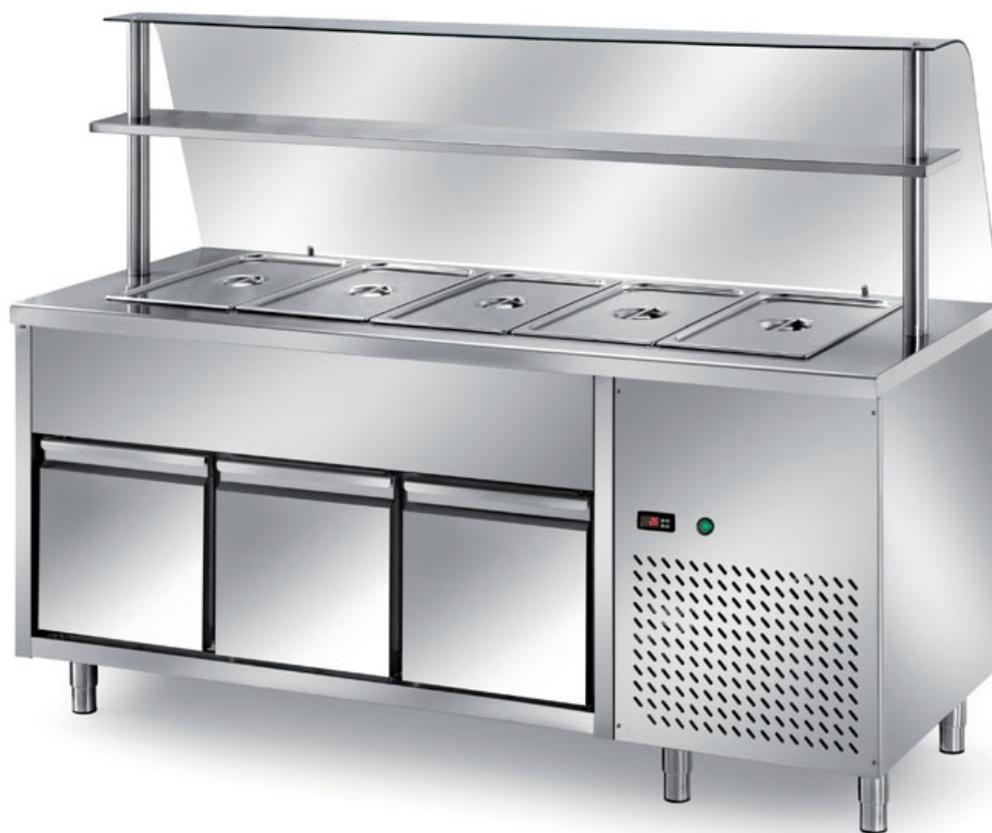
Tavolo freddo self-servie con vasca raggiata mm.200h - GN escluse - 3 ante refrigerate + vano motore - 1 controllo (temperatura vasca / temperatura vano). Dim. mm. 2000x700x1400h. + vetro curvo temperato - TMV/20
