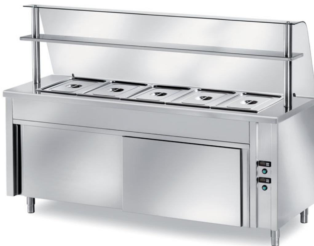
Tavolo caldo self-service vano inferiore caldo ventilato, 3000 Watt, tamburato, vasca raggiata h 200, capacità di n 5 bacinelle GN 1/1 h 150 (bacinelle escluse) mm 2000x800x1400 h + vetro curvo temperato - SFC8/20
