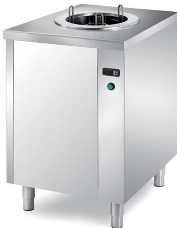
Tavolo distributore piatti riscaldabile 2 colonne regolabili. Capacità 100/120 piatti tondi diametro 190-260 mm. Regolazione termostatica digitale 20°C - 110°C. Kw 1,2 - 230 V - Hz 50 - TS8/2C
