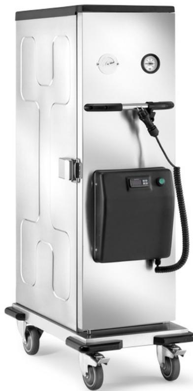
Carrello thermobox versione riscaldata con porta a battente, 0/+90°C, 900W, 230V, 50/60Hz, capacità 20xGNI/1 H40mm oppure 10xGNI/1 H100mm oppure 5xGNI/1 H200mm. Passo mm.55. - TNG/20C
