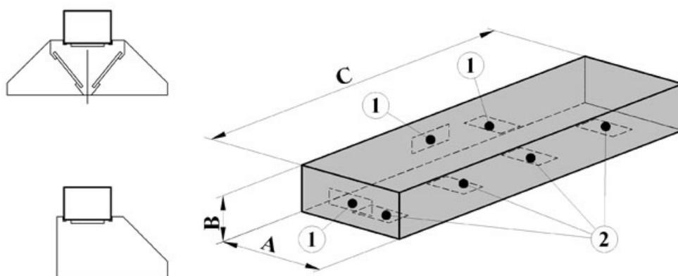
Plenum di aspirazione cm.65x40x380h.per cappe centrali 130 lung.400
