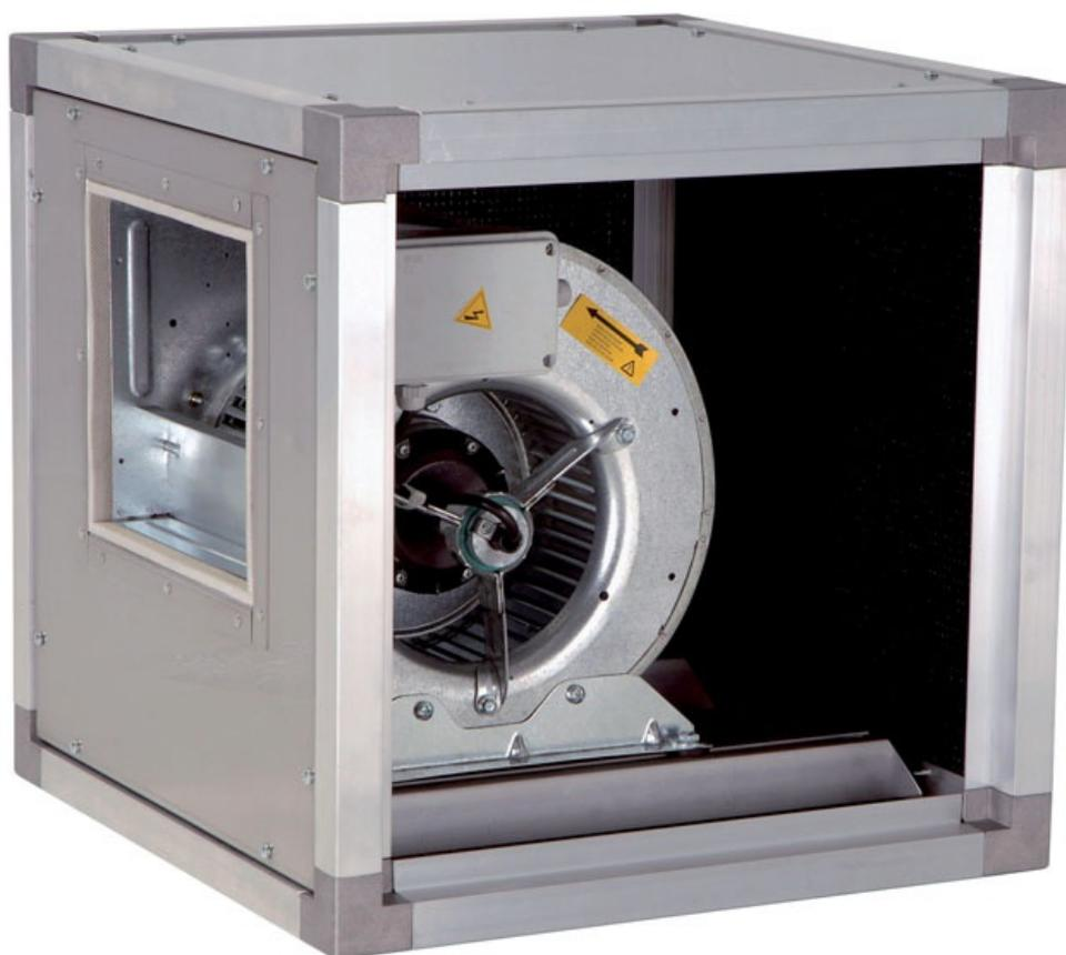
Aspiratore cassonato serie ACC con motore monofase direttamente accoppiato, portata 1200 mc/h, 930 giri, prev. hs20, 245 Watt. - ACC44LPV
