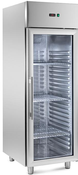
Kühlschrank, 1-türig (Glastür), Isolierung 80mm, automatische Abtauung und Tauwasserverdunstung, mit gedrückten Schienen, Digitalregler. 600 Lt. Beleuchtung und Schloß inbegriffen, Temp. -2/+10°C Abm. 710x830x2050 H mm - GRV250
