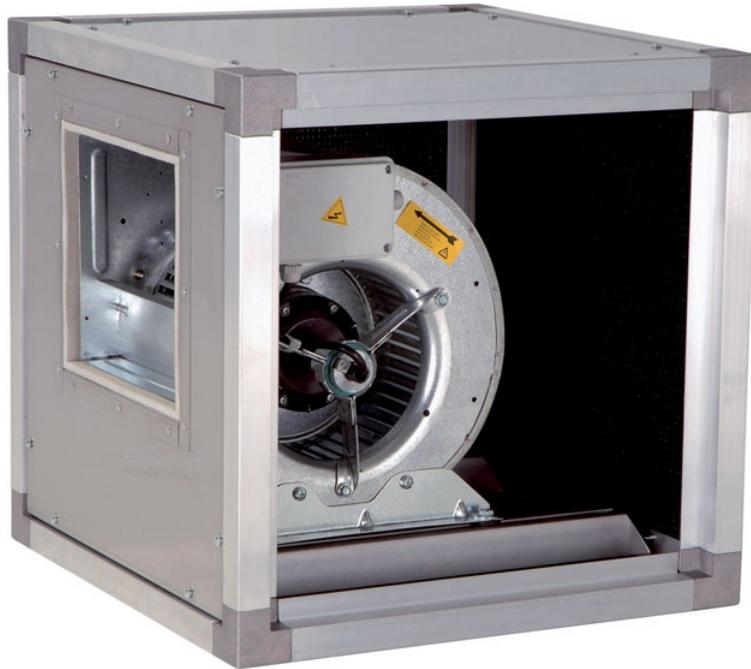
Kastenaspiratoren Mod ACC mit Einphasenmotor direkt verbunden, Kap 2500 mc/h, 1380 Umdrehungen, Präval. 42 hs, 147 Watt - ACC440LPV
